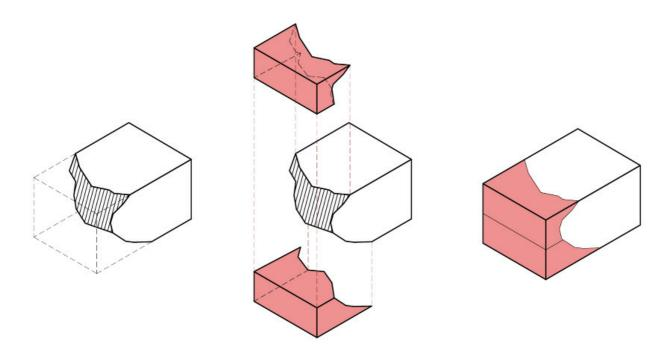
Puc. 5. Докомпоновка сложной конфигурации из нескольких бесшовно склеенных составных частей Fig. 5. Supplementing a complex configuration from several seamlessly glued components
