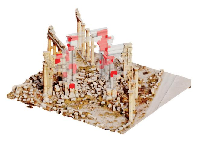
Puc. 3. Параметрическая первичная модель Арки в среде Autodesk Revit Fig. 3. Parametric model of the Arch in the Autodesk Revit environment
