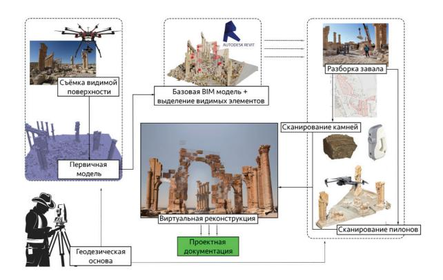
Рис. 2. Структура рабочего процесса по цифровому сопровождению посттравматичесского реагирования Fig. 2. Workflow for digital support of post-traumatic response
