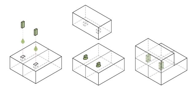
Puc. 6. Схема поэлементной сборки Арки с применением аутентичного принципа анкеровки Fig. 6. Scheme of the element-by-element assembly of the Arch using the authentic anchoring principle
