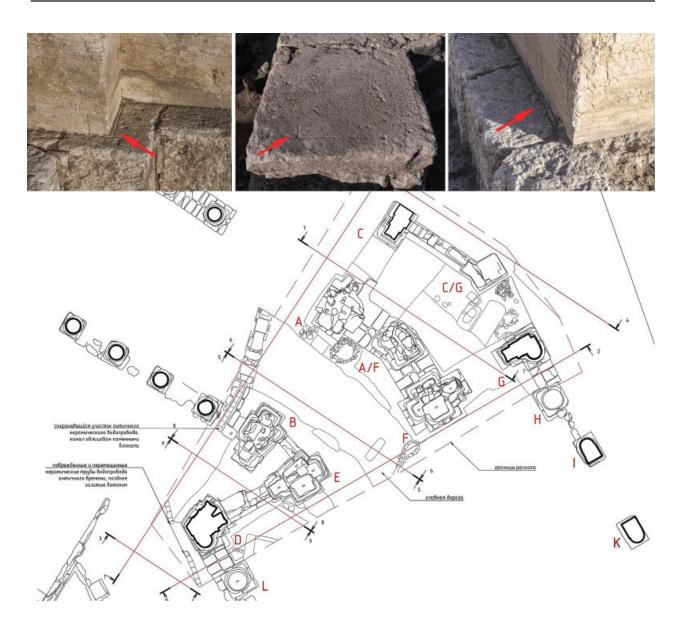
Рис. 17. План актуального состояния Арки с индексацией пилонов. Сохранившаяся разметка на верхних плоскостях фундаментных блоков пилонов D, C/G и F
