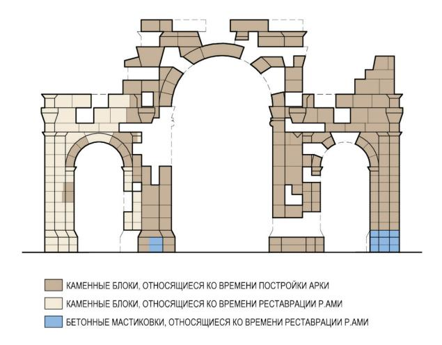
Рис. 2. Виртуальная модель Арки, в которой обрушенные блоки расположены на своих местах (изображение носит условный характер)
