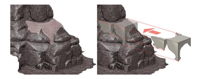
Рис. 10. Формообразование коронок на «родные» каменные блоки. Необратимый метод Fig. 10. Formation of crowns on original stone blocks. Irreversible method
