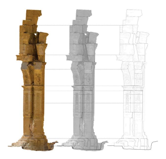
Рис. 4. Фасад пилона D. Перевод ортофотоснимка модели в чертеж Fig. 4. Facade of the pylon D. Converting the orthophoto from the model into a drawing
