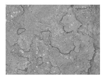
Puc. 8. Изображение структуры мраморизованного известняка, полученное с помощью сканирующего электронного микроскопа
