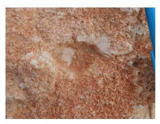
Puc. 20. Гидроокислы железа на поверхности стилолитового шва
