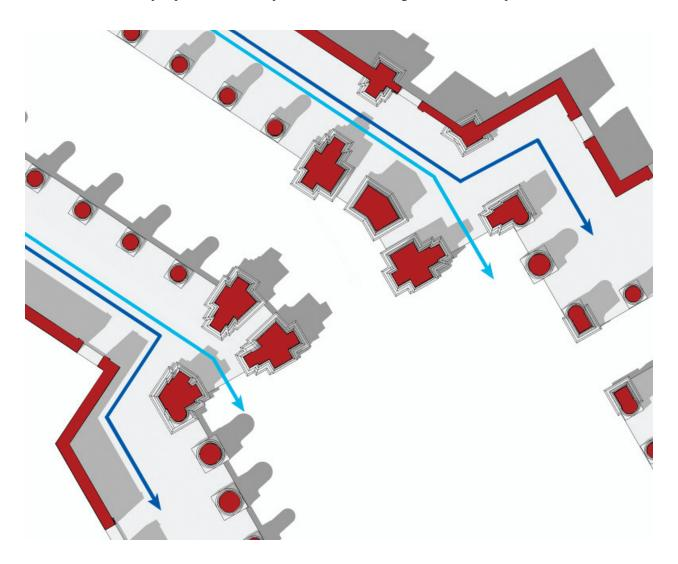
Puc. 18. Схема движения пешеходов в крытых боковых проходах колоннад Fig. 18. Scheme of pedestrian traffic in the covered side passages of the colonnades
