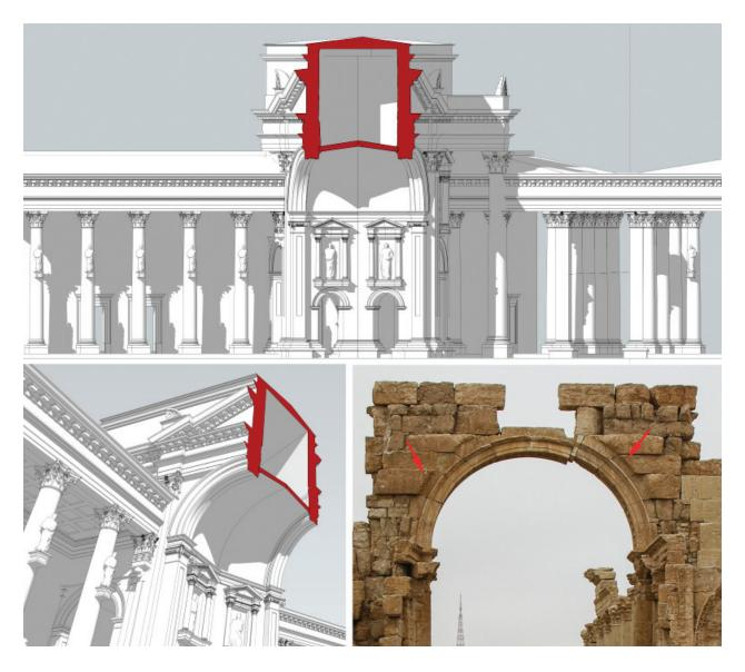
Рис. 16. Разрез посередине центрального пролета Арки. Снимки с рабочей трехмерной модели. Обратная сторона центральной арки северо-западного фасада, выше архивольта — выемки для плит свода арочного пролета. Фото с натуры
