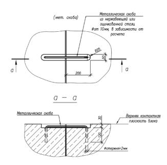
Рис. 15. Предложение по конструктивной связи каменных блоков из соображений сейсмической устойчивости. Указание на материал (металл) условно
