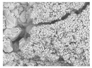
Puc. 9. Крупнокристаллические зоны мраморизованного известняка Fig. 9. Coarse-crystalline zones of marbled limestone
