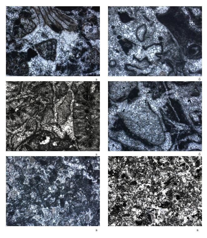
Рис. 7. Фотографии шлифов. Увеличение ×60. Николи скрещены: а) исторический камень; б) камень времен реставрации Р. Ами; в) камень с действующего современного карьера Fig. 7. Photographs of sections. Magnification x60. Nikoli crossed: a) historical stone; b) a stone from the time of
