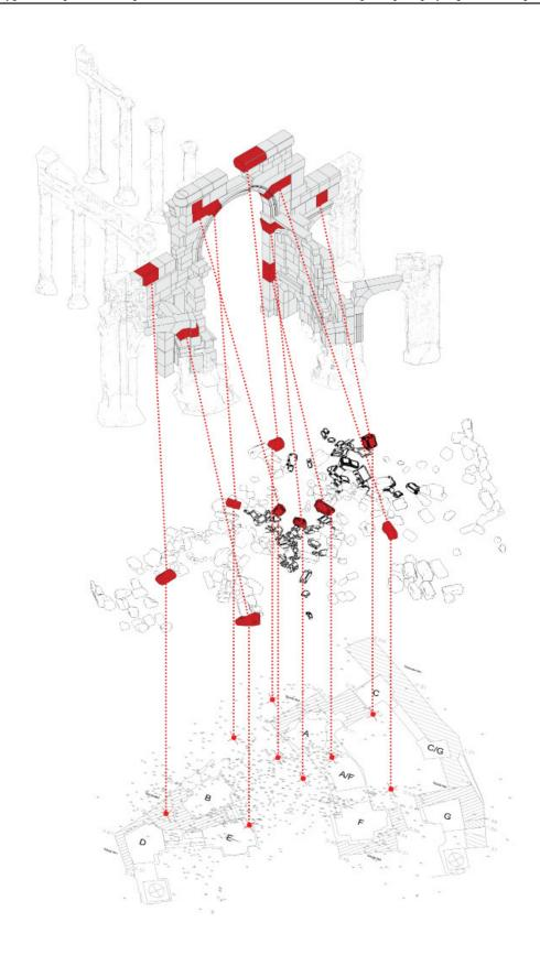
Рис. 14. Поиск блоков, признак 4. Сопоставление номера камня с топографической съемкой расположения камней в развале
