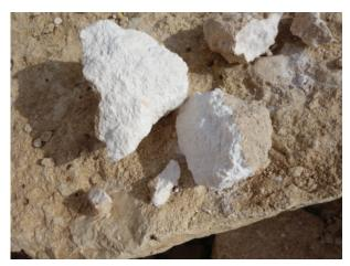
Puc. 4. Образец мела, использованного при строительстве Арки
