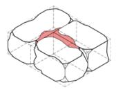
Puc. 4. Докомпоновка внутренних поверхностей каменных блоков для обеспечения конструктивной связности Fig. 4. Supplementing internal surfaces of stone blocks to ensure constructive connectivity
