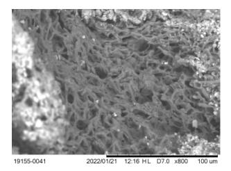
Рис. 27. Гифы грибов на поверхности камня Fig. 27. Hyphae of mushrooms on the surface of a stone
