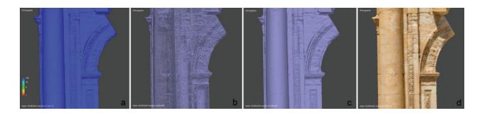
Puc. 6. Модель устоявших конструкций Арки с расчетами достоверности Fig. 6. The model of the standing structures of the Arch with mesh confidence indication
