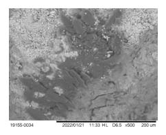
Рис. 25. Биопленка (темноокрашенная поверхность) на известняке
