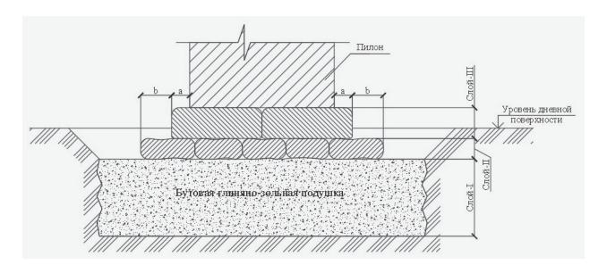
Puc.~9.~ Реконструированная общая схема устройства фундамента пилона: Слой-I; Слой-II; Слой-III; уступ а шириной 0,10-0,15 м; уступ b шириной 0,10-0,40 м Fig.~9.~ Reconstructed general layout of the pylon foundation: Layer-I; Layer-II; Layer-III; ledge a-0.10-0.15 m wide; ledge b-0.10-0.40 m wide
