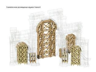
Puc. 13. Схема монтажных лесов и кружал Fig. 13. Scheme of scaffolding and arch falsework
