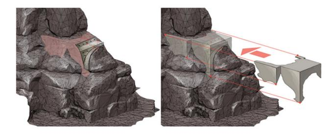
Рис. 11. Формообразование коронок на «родные» каменные блоки. Обратимый метод Fig. 11. Formation of crowns on original stone blocks. Reversible method
