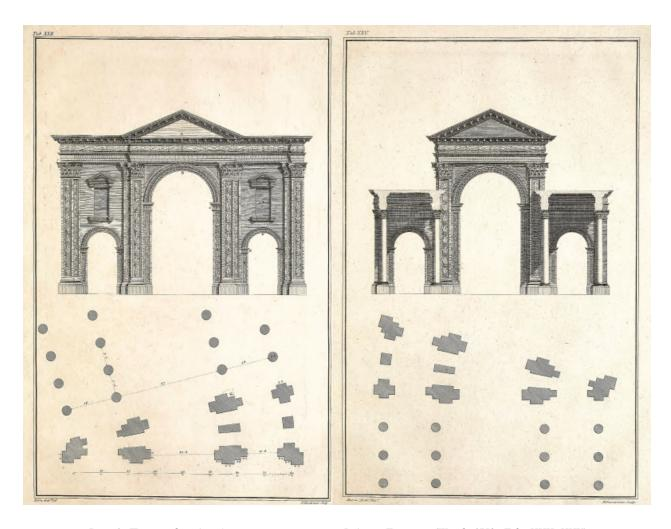
Puc. 1. План и фасады Арки в реконструкции Вуда и Докинза (Wood, 1753. Tab. XXII–XXV) Fig. 1. The plan and facades of the Arch in the reconstruction of Wood and Dawkins (Wood, 1753. Tab. XXII–XXV)
