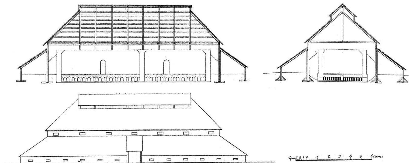
Рис. 1. Чертежи напольной кирпичеобжигательной печи: продольный и поперечный разрезы, фасад.
