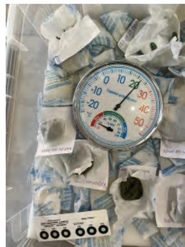
Рис. 15. Прибор, при помощи которого измерялся уровень влажности внутри контейнеров (герметичный контейнер являлся важным элементом микросреды)
