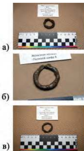
Рис. 1. Этапы реставрации железного кольца: а – состояние кольца до реставрационных мероприятий; б – кольцо после механической расчистки; в – кольцо после реставрации
